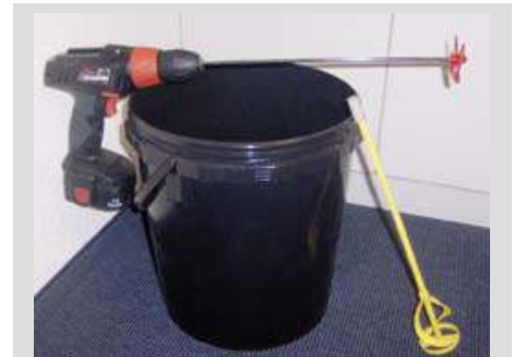
A kis edényeknél egy megfelelő rátéttel felszerelt akkufúró alkalmas a keverésre
