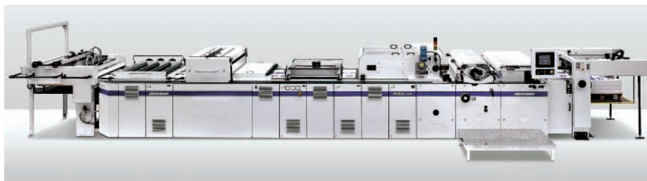
Die Hibis 104, die sich als Rundsieb- oder Kammerrakel-Lackieranlage einsetzen lässt.
