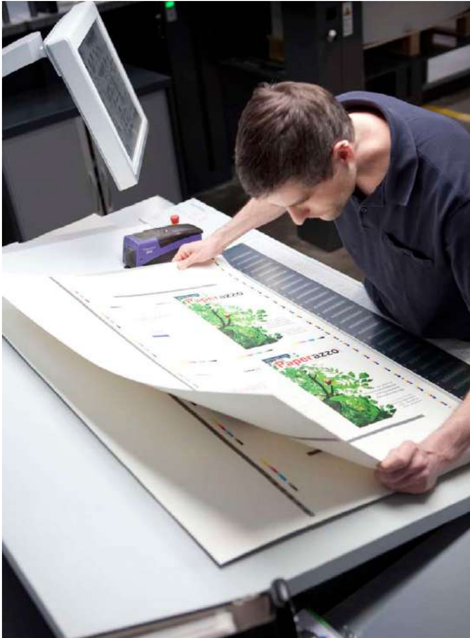
A borítót először egy Speedmaster XL 105-ön négy EURO skála szerinti színnel és egy matt alapozóval látták el.
